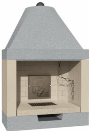
**CAMINETTO PREFABBRICATO A LEGNA A FOCOLARE APERTO COMPLETO DI PARAFIAMMA IN GHISA (4,5 KG), VALVOLA FUMI, VASCHETTA RACCOGLI CENERE E GRIGLIA IN GHISA. STRUTTURA REALIZZATA IN CONGLOMERATO CEMENTIZIO ALLEGGERITO. FOCOLARE REALIZZATO IN REFRAATTARIO AD ALTO TENORE DI ALLUMINA. POSIZIONABILE SIA AD ANGOLO CHE A PARETE, IDEALE PER LA COTTURA DI CIBI ED ARROSTI.**
